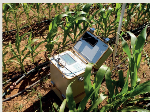
Figura 3 – Equipamento para medição do teor de água no solo a diferentes profundidades
