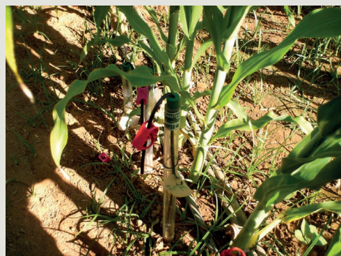
Figura 2 – Sistema de cápsulas porosas para recolha da solução do solo a diferentes profundidades
