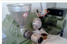
Figura 5 – Equipamento de extração a frio de óleo de sementes e óleo e sementes (Fonte: http://cactusextractus.blogspot.pt )
