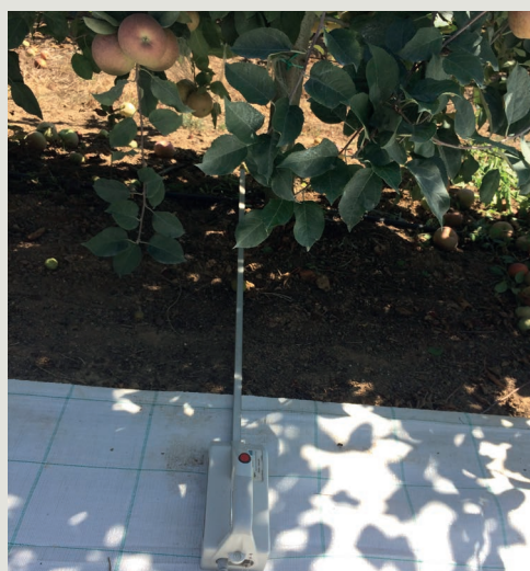
Figura 3 – Medição da radiação PAR com ceptómetro
