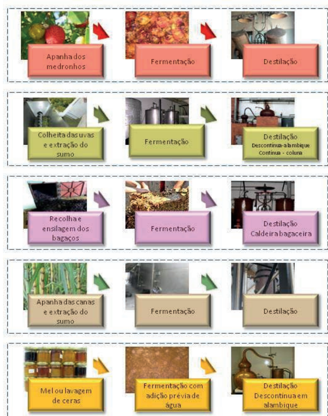
Figura 1 – Representação esquemática simplificada do processo de produção de cinco tipos de aguardente em Portugal: aguardente de medronho, aguardente vínica, aguardente bagaceira, rum da Madeira e aguardente de mel
