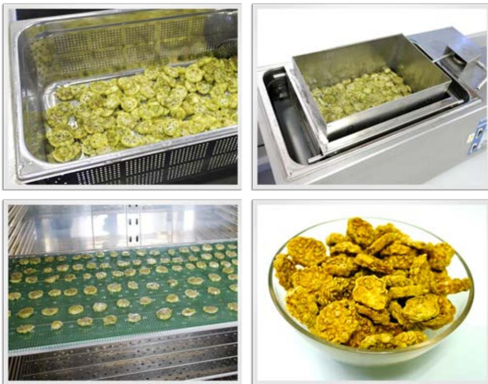
Fig. 4.13 – Etapas do processo osmótico combinado com secagem e produto final.
