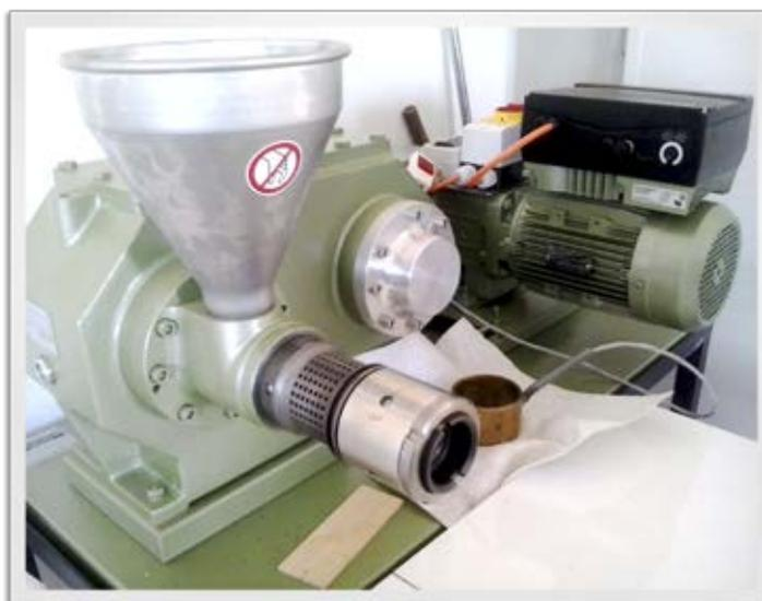
Fig. 4.19 – Equipamento de extração a frio de óleo de sementes.
