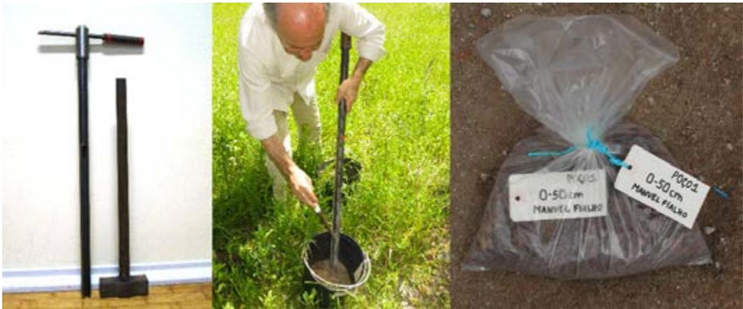
**Figura 12** – Equipamento necessário à colheita de amostras de terra e amostra para envio ao laboratório
