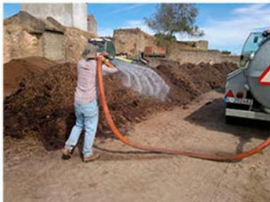
Figura 7 - Humedecimento da pilha
