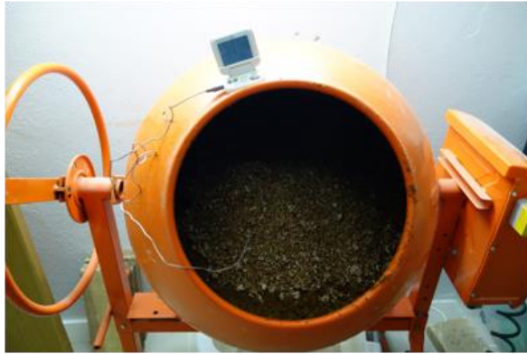
Figura 12 - Misturadora (betoneira adaptada) para preparar substrato
