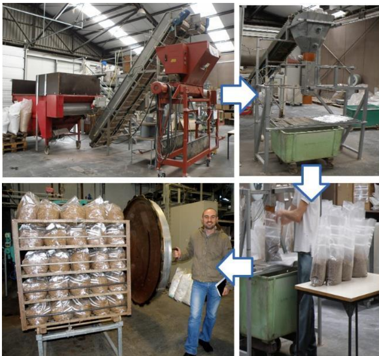
Figura 21 - Misturadora e elevação de substrato, máquina de enchimento, enchimento, cesto de autoclave e porta de autoclave
