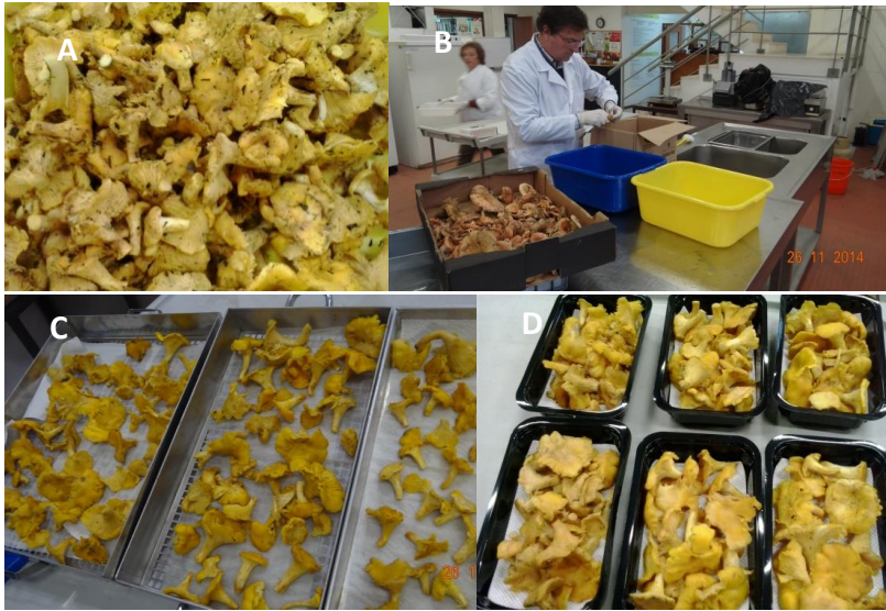
Figura 2 - Etapas do processo tecnológico de cogumelos em fresco: A - recepção; B - limpeza; C - desinfecção; D - embalagem
