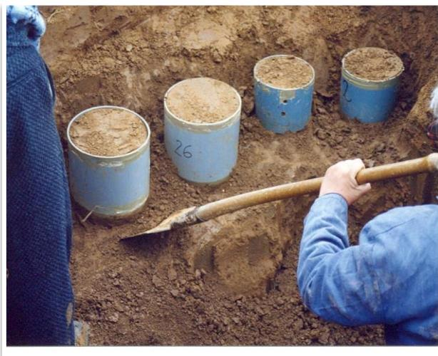
Figura 4. Retirada dos cilindros de PVC com as amostras de solo, utilizando uma pá plana.
