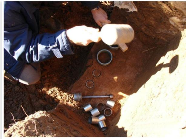
Figura 2. Colheita de cilindros (pvc e aço inox) num patamar de uma cova.
