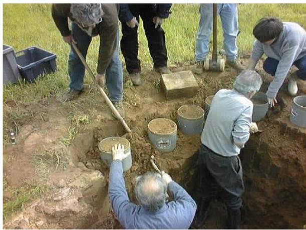
Figura 3. Colheita de amostras de maiores dimensões, com remoção do solo em redor do cilindro.
