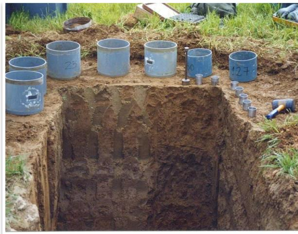
Figura 1. Cilindros colectores de várias dimensões, colhedor de punho e martelo
