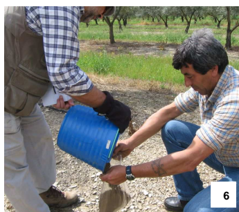
Fig. 5 – Misturar a terra e eliminar pedras ou outros detritos
