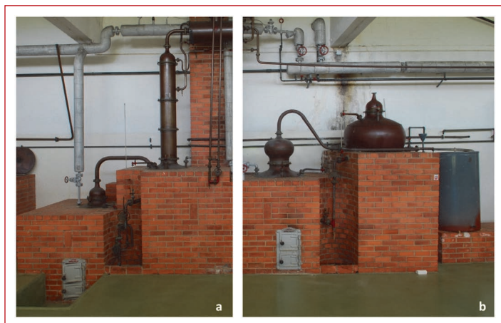
Figura 1 - Sistemas de destilação: (a) Coluna de destilação; (b) Alambique "Charentais".
