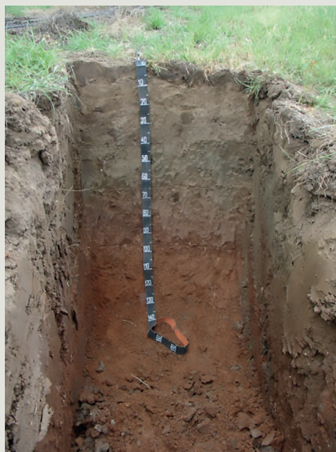
Figura 3 – Perfil de um Solo Mediterrâneo Pardo, de Materiais Não Calcários, Para Hidromórfico, de arenitos (Pag), com compactação grande a muito grande nos horizontes do solo 2Btg 1 (35/40-65 cm) e 2Btg 2 (65-90/95 cm)
