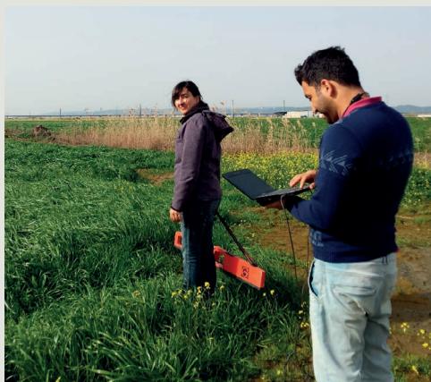
Figura 1 – O equipamento portátil de indução eletromagnética em medições na Lezíria
