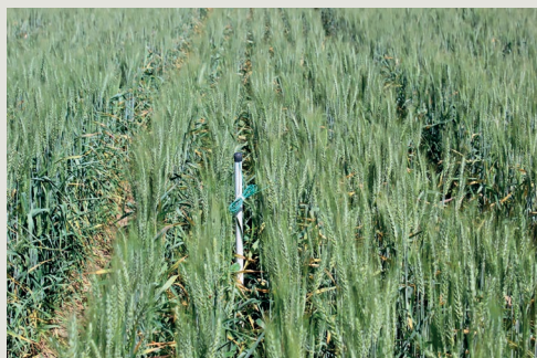
Figura 2 – Sonda Watermark de registo pontual para monitorização da humidade do solo durante o ciclo cultural, instalada no ano 2019
