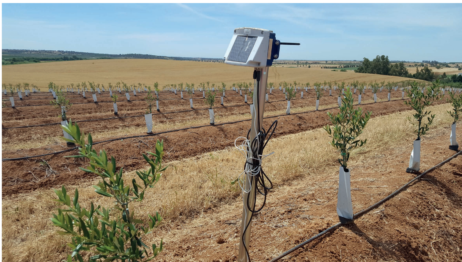
Figura 1 – Olival superintensivo (Local 10) no início das monitorizações em maio de 2019. Em primeiro plano, a sonda capacitiva para medição do teor de água a várias profundidades
