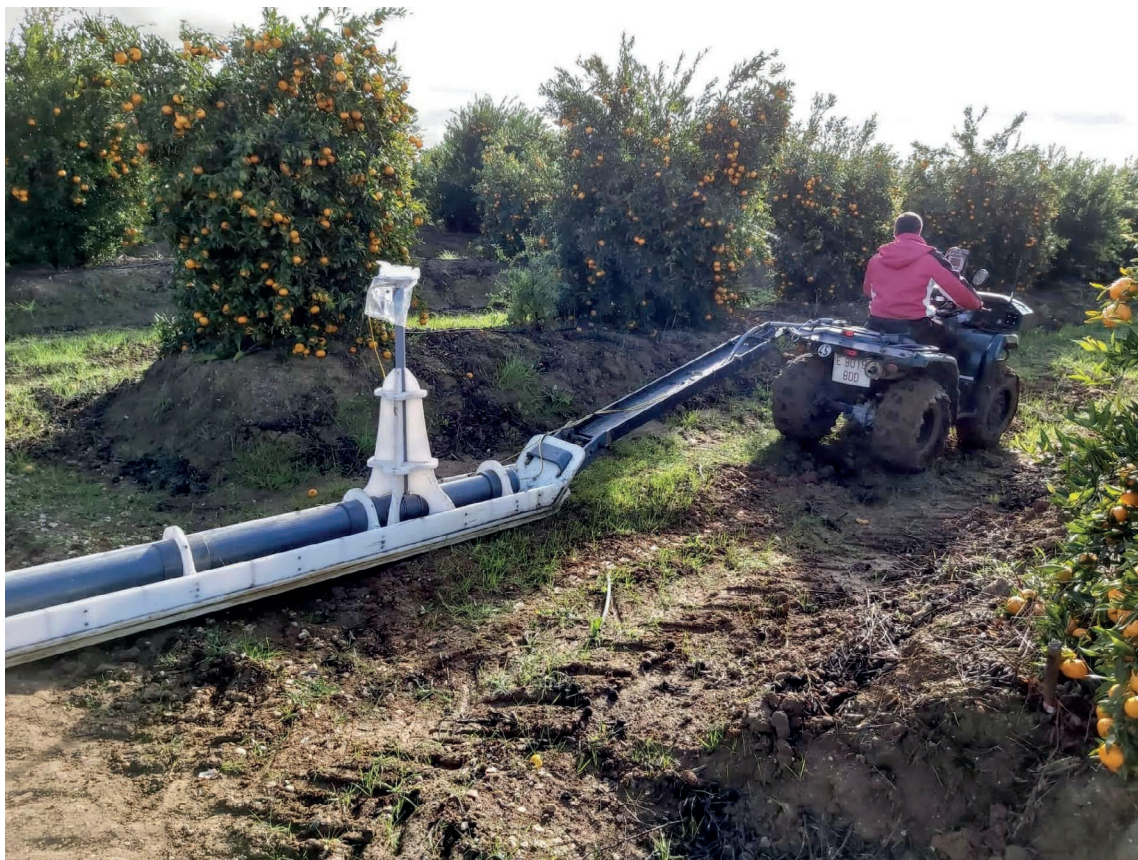
Figura 2 – Medição da ECa do solo com o equipamento DualEM-21 no local 8 (Citrinos – Tangerinas)
