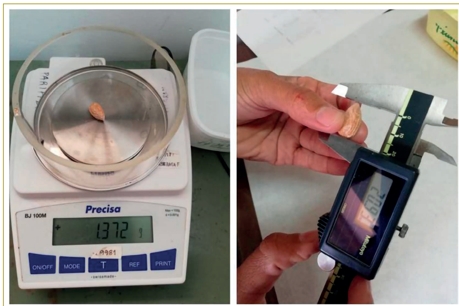
Figura 3 – Medição do peso (esquerda) e medição do comprimento (direita) do endocarpo.
