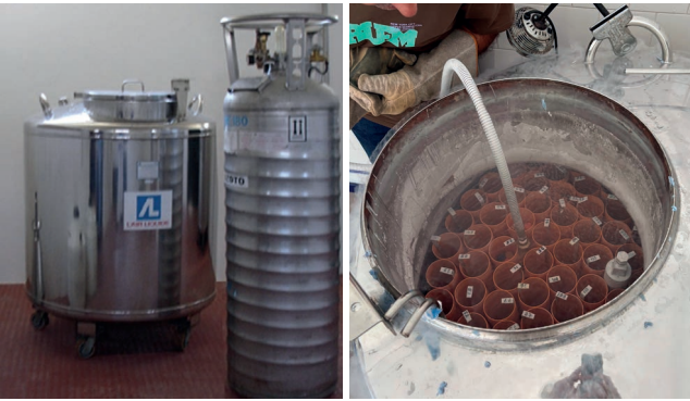
Figura 4 – Contentores com amostras de sêmen mergulhadas em azoto líquido (-196 °C) no BPGA.
