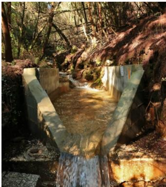
Figura 5 - Infraestrutura hidráulica "H-flume" utilizada para avaliação de caudal e outras respostas hidrológicas ao nível de uma bacia hidrográfica experimental (fonte: RAIZ).
