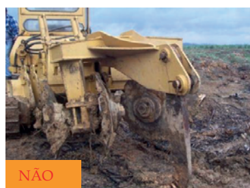
Figura 10 – Mobilização com excesso de humidade no solo, operação que só contribui para a compactação do solo e dificulta o desenvolvimento das raízes
