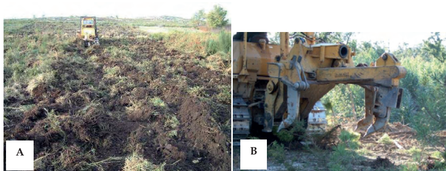
Figura 9 – Controlo da vegetação espontânea e mobilização do solo: A - gradagem segundo as curvas de nível; seguida, se necessário, de B - ripagem simples (para plantação no local de passagem do dente do ríper), se necessário ripagem cruzada, em que a última passagem é realizada à curva de nível
